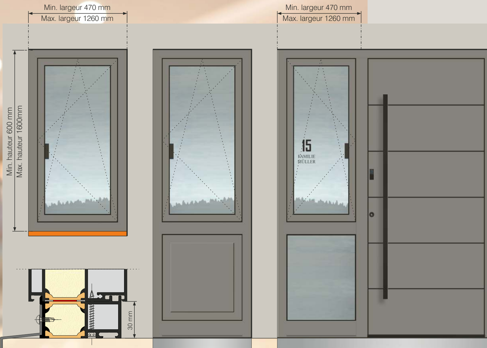
TYP ST 105 Partie latérale vitrée avec le vantail D/DK et profil de partition en hauteur de 30 mm.
