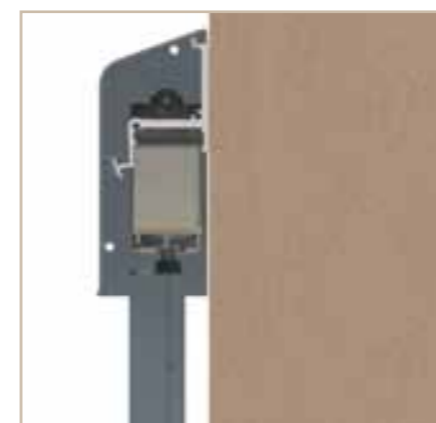
Bandeau (alu laqué ou selon label Qualimarine) allongé pour dissimuler la motorisation
