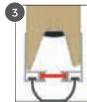
3 Profil bas en aluminium à rupture de pont thermique
